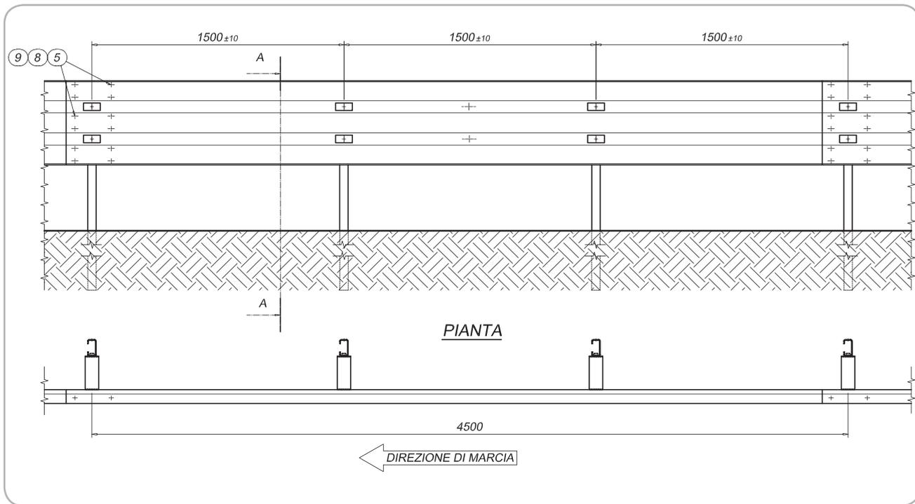
Figura 2: Vista frontale e Figura 3: Vista dall'alto della barriera 3n35975.
