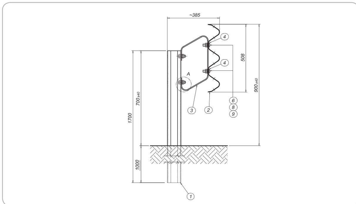
Figura 1 Vista laterale della barriera 3n 35975.
